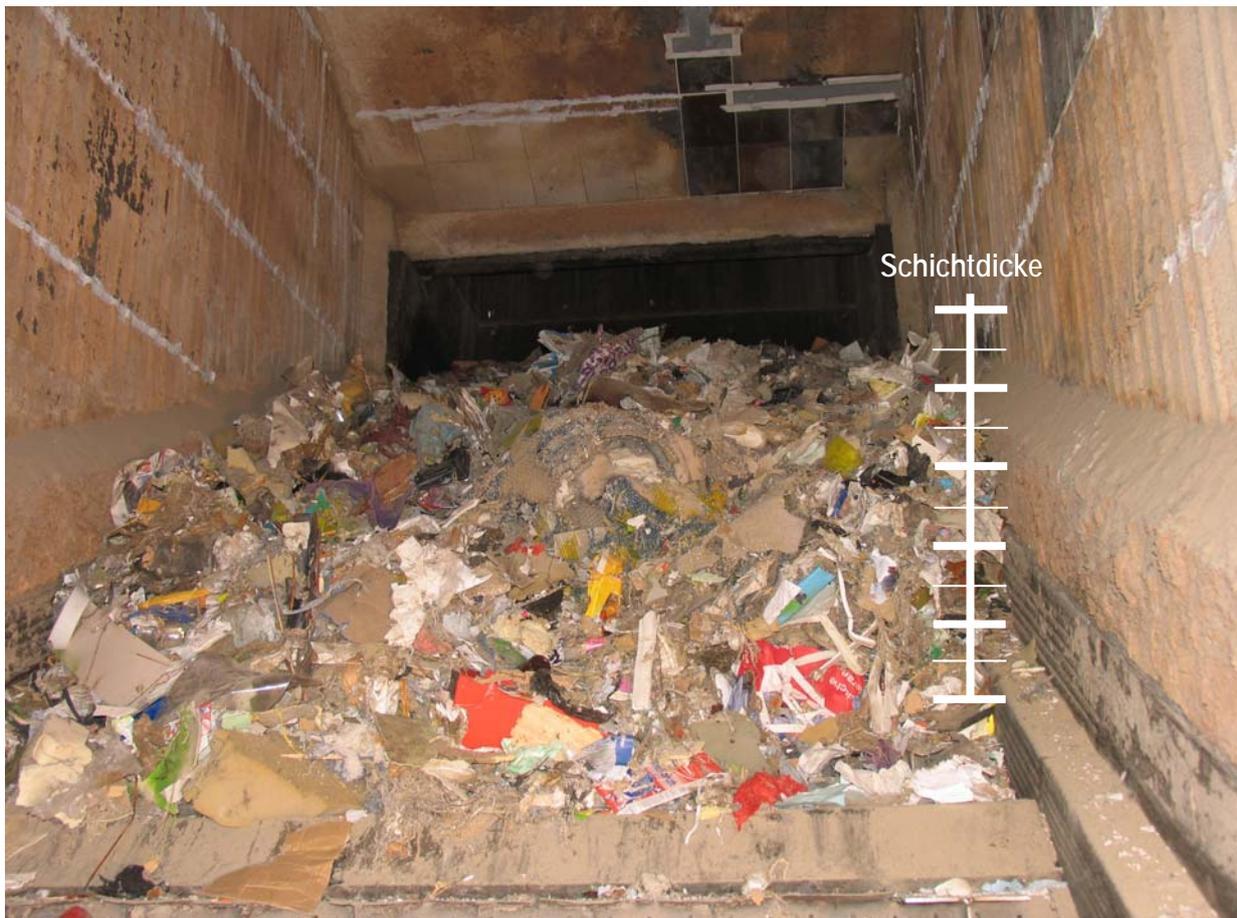
**Abbildung 26: Versuch zur Ermittlung der Müllschichtdicke**
