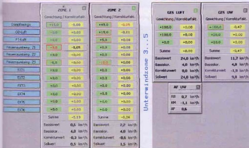
Bild 13: Gewichtung der einzelnen Regler auf die entsprechenden Stellorgane (Beispiel Unterwindzonen, Gesamtluft und Unterwind gesamt)
